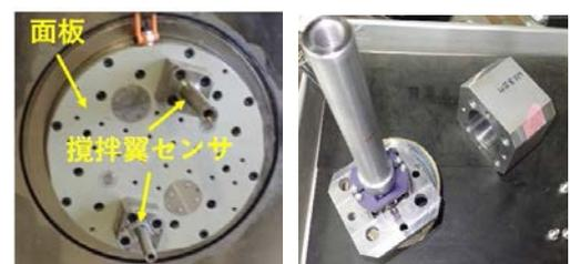
(a) 面板取付状況 (b) 攪拌翼センサ
