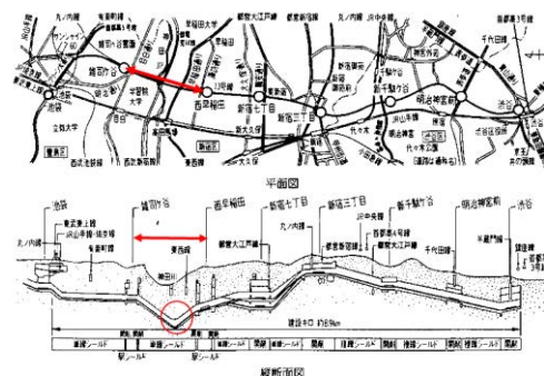
図 1 東京メトロ副都心線平面・縦断面図
