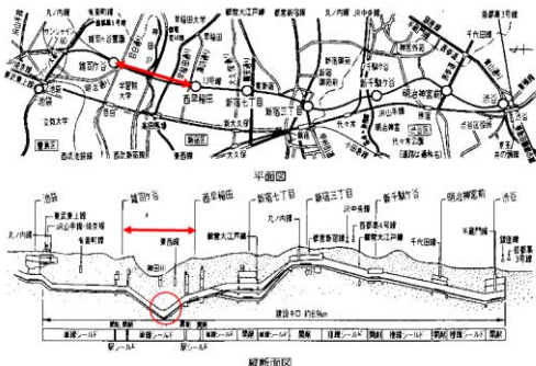
図 1 東京メトロ副都心線平面・縦断図
