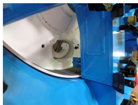
写真-1 親子シールド機チャンバー下部
