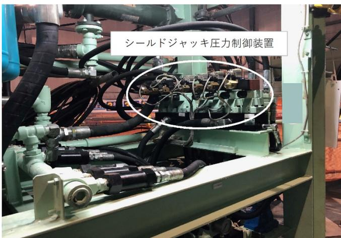
写真-1 圧力制御装置
