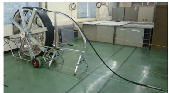
図-2 光ファイバ3次元変位計測センサ
