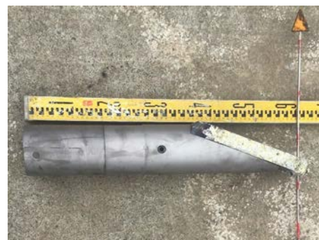
写真-2 削孔ロッド先端部
