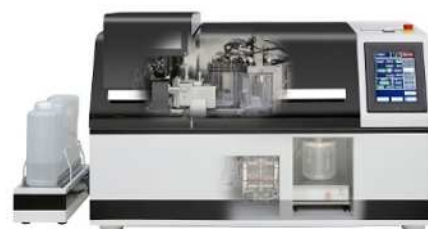
図-4 MSE 室内試験装置
