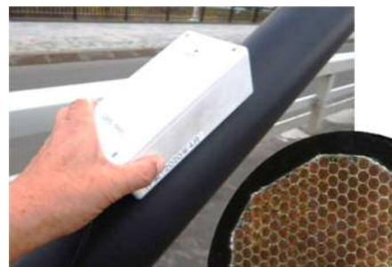
Fig.1 計測状況とケーブル模型断面
