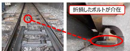
図-2 ポイントガード取付用ボルトの折損による分岐器不転換
