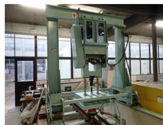
図 6 重錘落下試験装置
