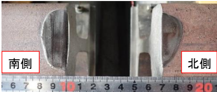
図 3 10 万回载荷後のレール頭頂面端部
