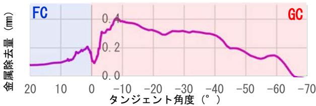
図-1 現行の削正パターンの金属除去量
