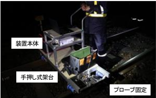
図1 現地測定の状況
