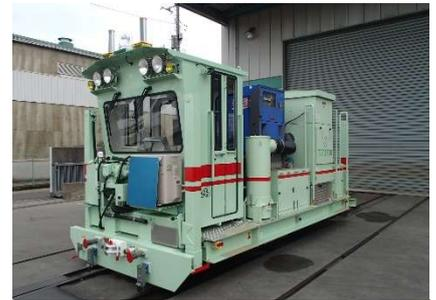
図-1 4頭式波状摩耗削正機
