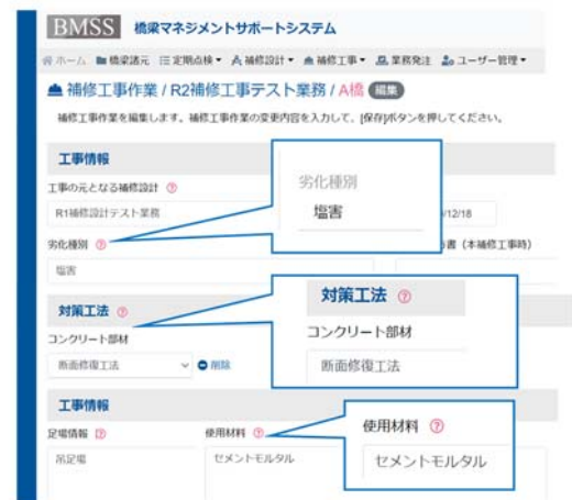
図-5 補修工事画面
