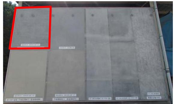
写真-5 表面被覆の試験施工
