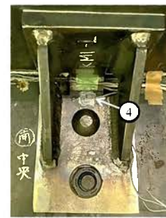
図 6 補強部材のひずみゲージ④
