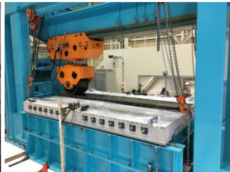
写真-3 輪荷重走行試験状況
