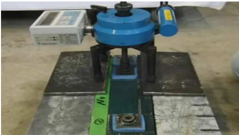
写真-4 付着強度試験
