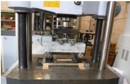
写真-2 3等分点載荷によるひび割れ導入状況
