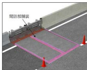
図-5 床版取替1日目 施工ステップ図
