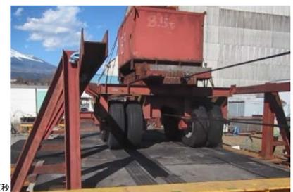
写真-2 輪荷重走行試験状況
