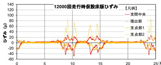
図-7 仮設床版ひずみ計測結果
