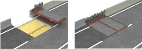
図-6 仮設床版システム概要図
