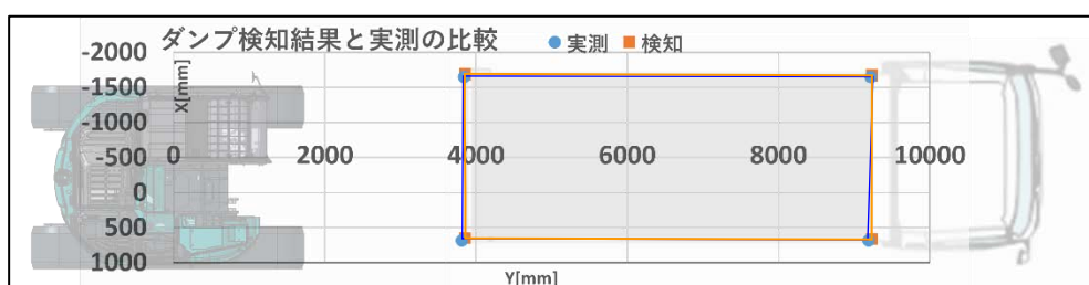
図-2 ダンプ荷台位置の検出結果
