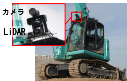
写真-2 搭載したLiDARとカメラ
