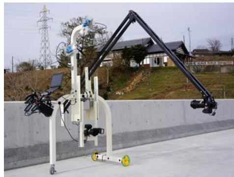
図3 壁高欄測定ロボット
