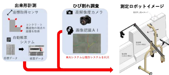
図1 出来形計測ロボットの概要
