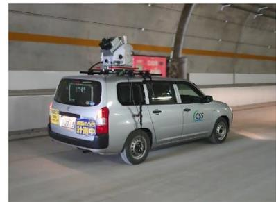
写真 2 MMS 計測状況
