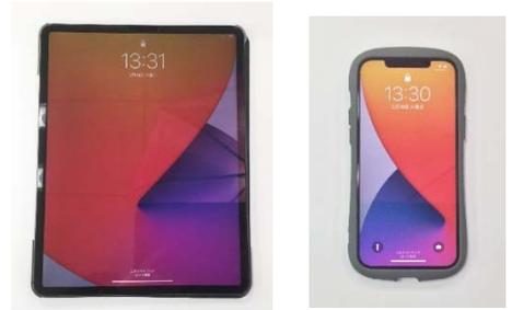
写真1 LiDAR 搭載モバイル端末
