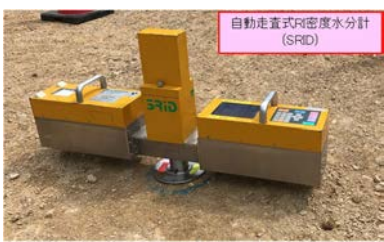
写真-2 SRID による計測状況
