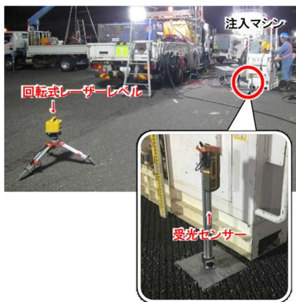
図-3 ワイヤレス沈下・隆起計測システムによる計測状況
