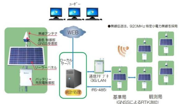
図-1 RTK-GNSS 地盤変位計測システムの概要図
