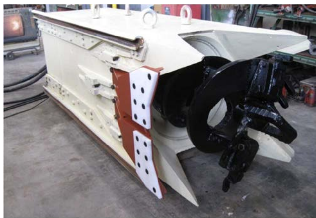
図-5 オーガータイプ掘削装置
