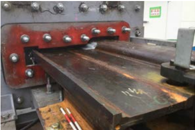
図－6 継手試験体挿入状況
