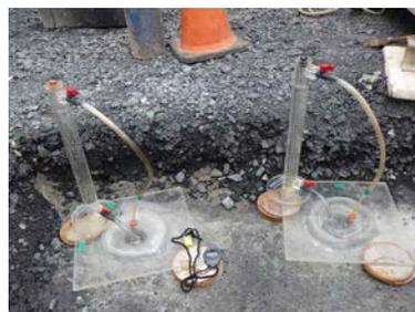
写真-2 現場透水試験状況
