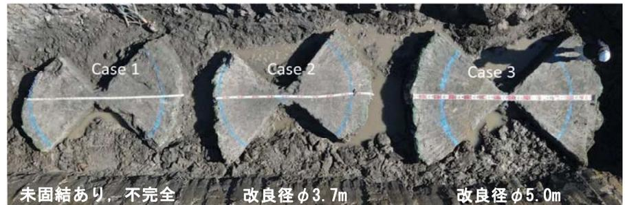
写真1 改良体の露出状況（90° 揺動，写真上面は砂質シルト）
