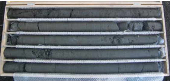
写真2 ボーリングコア (現場 1 φ 1.3m)
