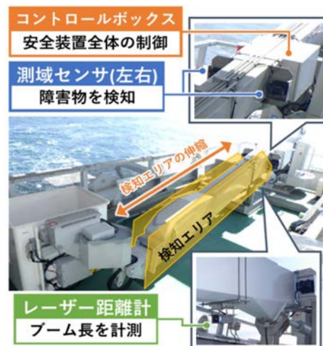
図-4 接触防止装置の構成
