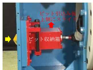
写真5 ①旧ビット収納箱引込み
