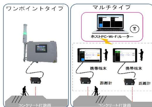
図-1 装置概要図
