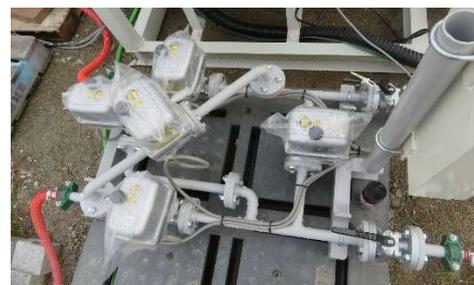
写真-2 方向制御用バルブセット
