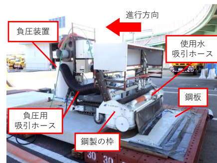
写真-3 使用水処理の工夫
