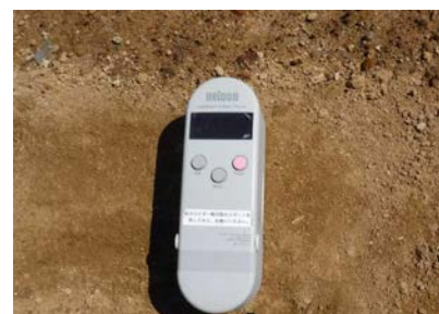
図-2 ポータブル摩擦計による測定状況
