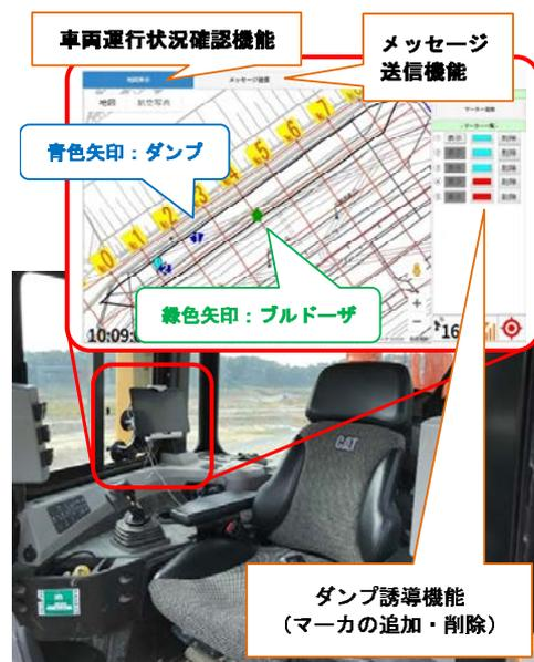
図-3 G-Safe 端末の設置状況 (ブルドーザ運転席)
