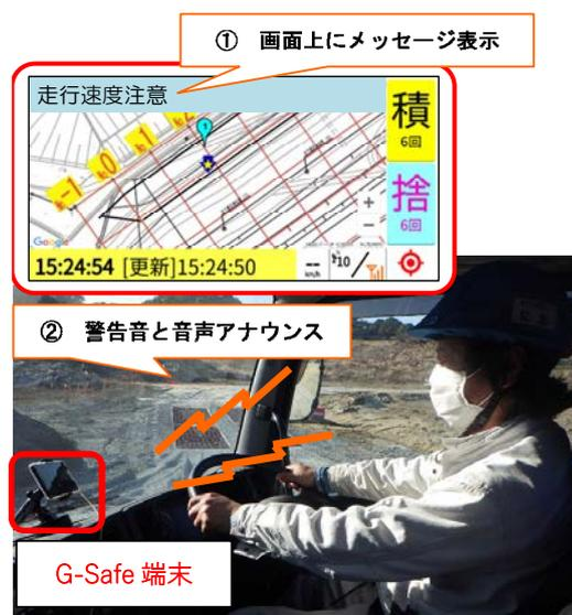
図-1 G-Safe 端末の設置状況（ダンプ運転席）
