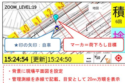
図-2 G-Safe 端末での荷下ろし目標表示状況
