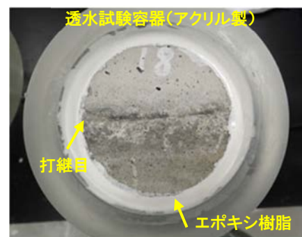
写真-4 透水試験体の設置状況
