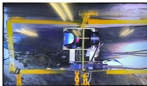
写真-5. 2D レーザースキャナ設置状況
