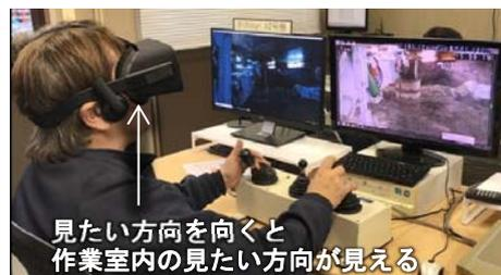
写真-4. ヘッドマウントディスプレイによる遠隔確認状況
