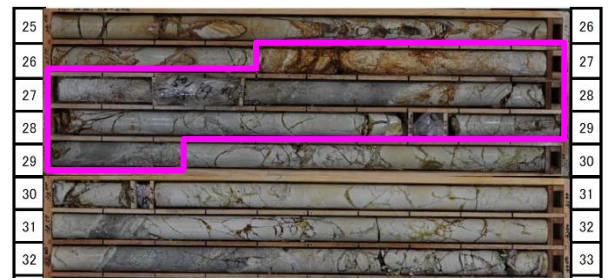
写真 4 ボーリングコア（H27-Bor.No.2; 25～33m）
