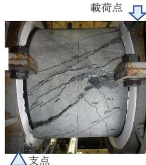
図-2 Case1 のせん断破壊の状況
