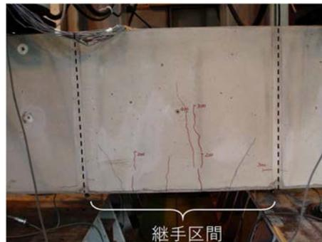
写真-2 疲労試験ひび割れ状況
