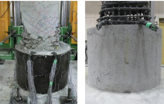
写真1 ひび割れ状況 (No.1 試験体)
