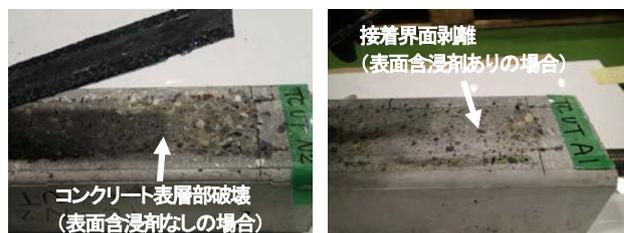
写真1 破壊状態
