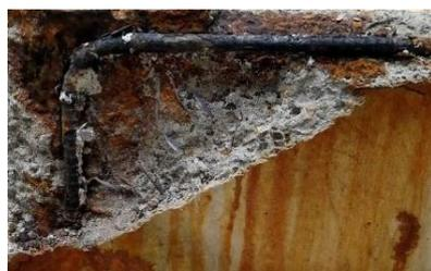
図7 破壊時の様子(全体腐食)
