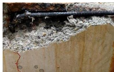
図8 破壊時の様子(直線部腐食)
